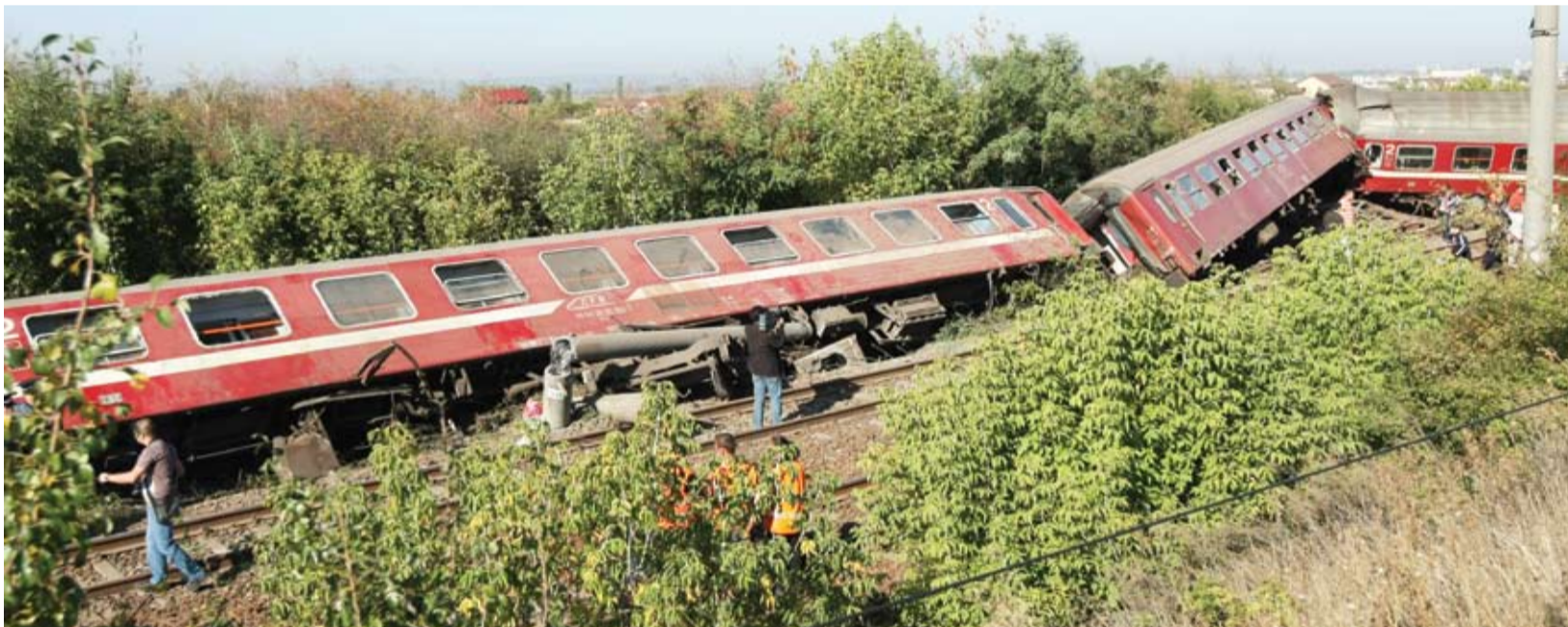
Trenul a sărit de pe linia ferată, la mică distanță de vagoanele deraiate fiind găsite bucăți de șină, mai multe șuruburi și un bidon cu o substanță specială. FOTO: L. NICA
